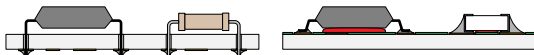
2. típus: egyoldalasan forrasztott vegyes szerelés: felületszerelt alkatrész az egyik oldalon, furatszerelt alkatrész a másik oldalon
